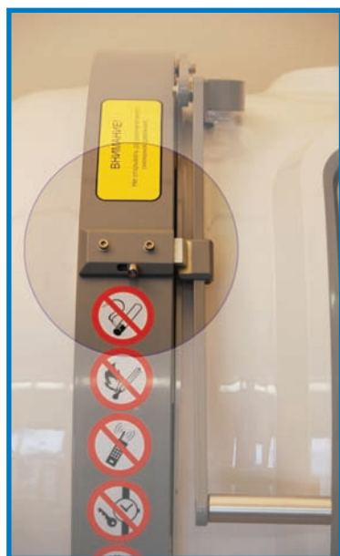
Конструкция барокамеры имеет блокировку рычага замка открытия крышки
